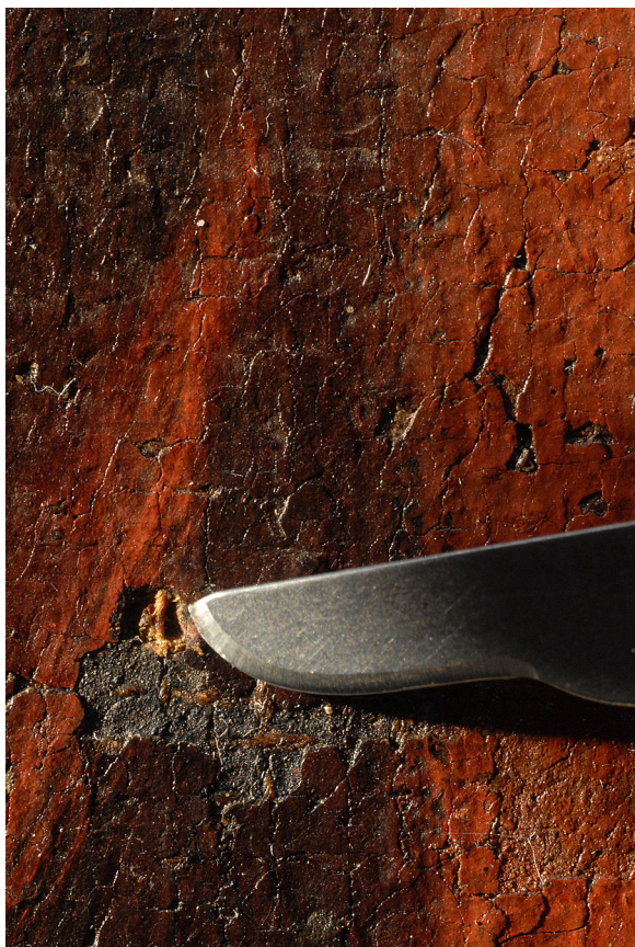
Bild 15. Vid färgsnittsprov är det viktigt att dokumentera var på målningen som provet tas. Dokumentationsbild från teknisk undersökning av Johannes Döparen i december 2012. Foto: © Emmebi Diagnostica Artistica s.r.l. Upphovsrättsskyddad.
